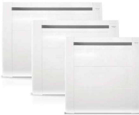
» L'élément chauffant est constitué d'une pierre céramique chauffée par une résistance qui libère de la chaleur pendant plusieurs heures. La pierre recueille et accumule la chaleur produite par les résistances électriques intégrées au matériau et, une fois l'appareil éteint, la restitue lentement, ce qui permet d'économiser de l'énergie.
